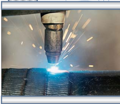
Endurecimiento superficial con «Arco Rápido».
