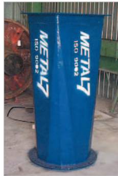
Pièce de transition avec revêtement intérieur de carbure de chrome. Transition part with Chromium Carbide interior overlay.
