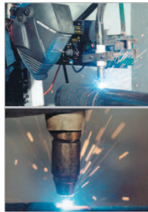
Soudure à l'arc ouvert. Open Arc Weld.
