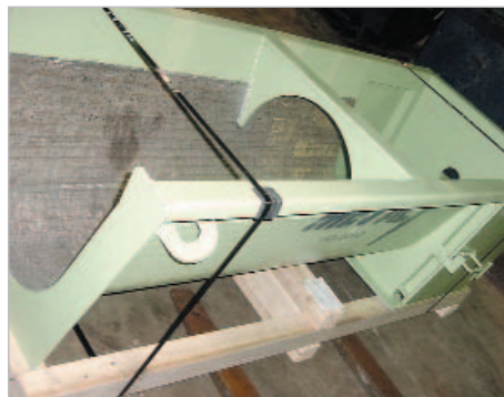
Auge à écorce. Bark conveyor housing.
